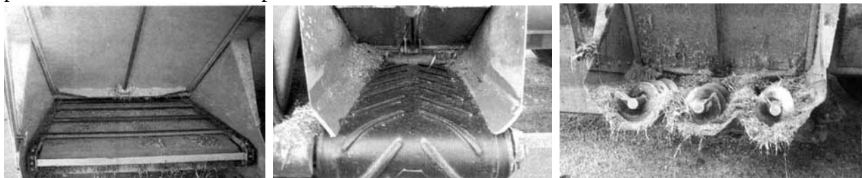
Fig. 6 - Sono diversi i sistemi in uso per depositare il prodotto in cumulo lineare sul bordo della trincea (catene, palette, nastri in gomma, coclee, ecc.), ma tutti devono prevedere degli appositi carter sui lati.
