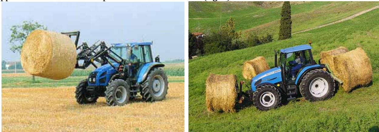
Fig. 1 - Il carico in campo e lo scarico in azienda delle balle vengono effettuati tramite forche o pinze, montate su sollevatori applicati anteriormente e/o posteriormente al trattore.
