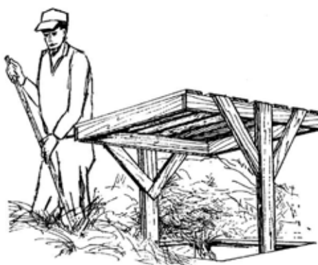
Figura 3 – Protezione botola durante lo scarico del fieno.
