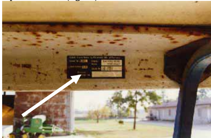
Fig. 20 - Sul telaio o sulla cabina devono essere riportati gli estremi di omologazione, punzonati o su una targhetta rivettata o incollata, collocata in un punto visibile.
