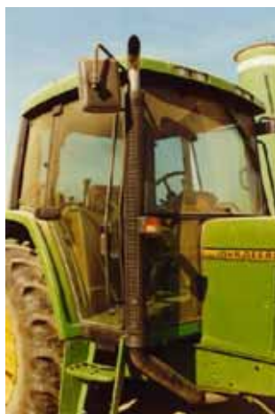
Fig. 19 - Le parti calde e soggette ad alte pressioni (silenziatore e condotti di scarico, serbatoio e tubazioni dell'olio idraulico), devono essere opportunamente protette, se la loro temperatura durante qualsiasi fase di funzionamento della macchina ecceda i 50°C e la pressione i 50 bar.
