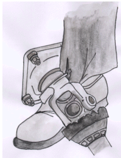
Fig. 1 –Intrappolamento nell'albero cardanico di lembi di indumenti
