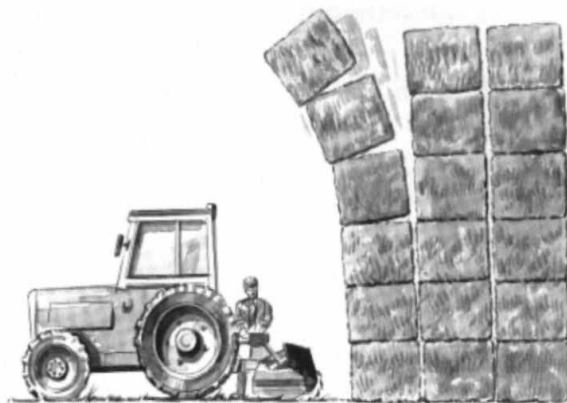
Figura 4 – L'impilamento di un numero superiore a quattro rotoballe può causare lo schiacciamento dell'operatore.
