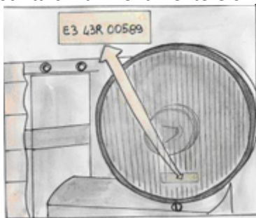
Fig. 1 - I fanali, come le luci di posizione e di arresto, gli indicatori di direzione, ecc. sono dispositivi fondamentali per la sicurezza e, pertanto, soggetti ad omologazione.
