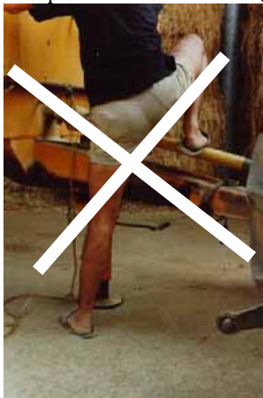
Fig. 6 - E' pericoloso utilizzare i tubi telescopici come punto d'appoggio per la salita o la discesa dalla macchina.
