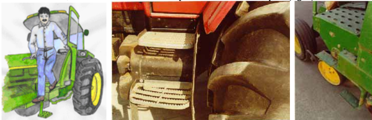
Fig. 5 - I gradini devono essere costituiti da materiale antisdrucciolevole, con una conformazione che permetta lo scolo dei liquidi.
