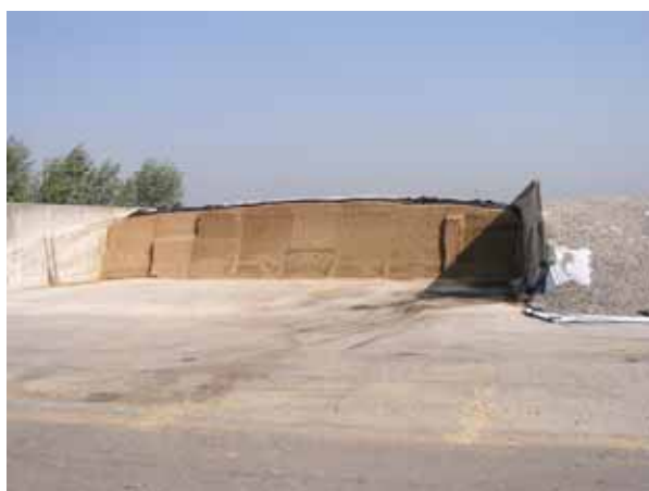
Figura 17 – Silo a trincea (o a corridoio).
