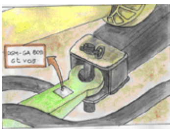
Fig. 12 - L'occhione che correda l'operatrice trainata deve essere sottoposto a prove di omologazione, per cui deve riportare sulla propria superficie gli estremi relativi, punzonati o in rilievo.
