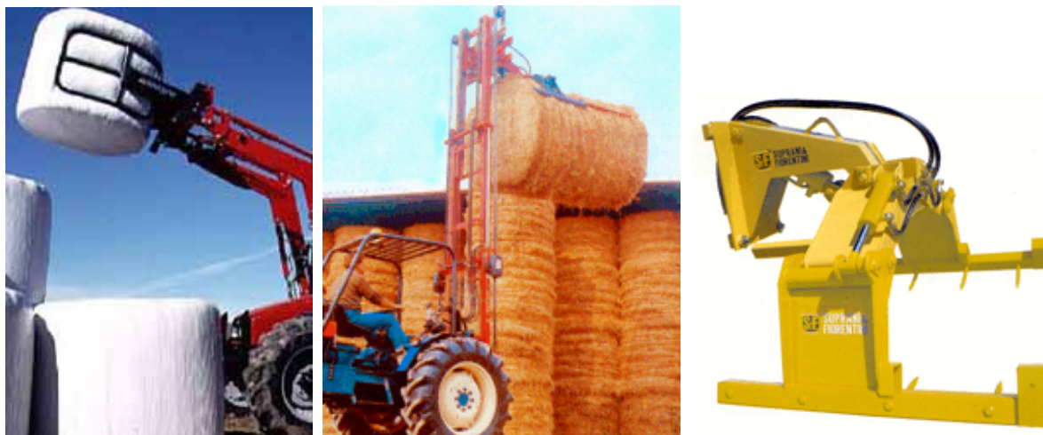
Fig. 3 - Per il sollevamento delle balle, si sono diffusi recentemente interessanti sistemi a pinze, sia semplici (che salvaguardano l'integrità del prodotto imballato, a sinistra), sia dentate (al centro e a destra) che permettono una presa sicura anche per situazioni impreviste.
