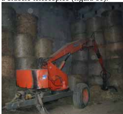
Figura 9 – Gru per movimentazione rotoballe
