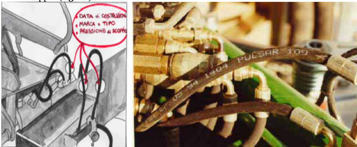
Fig. 17 - I raccordi e le tubazioni delle macchine di nuova costruzione devono riportare gli estremi del costruttore, la data di fabbricazione e i valori della pressione di lavoro e di scoppio.
