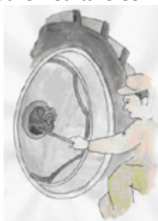
Fig. 9 - Tutti i bulloni di fissaggio della ruota alla flangia del semiasse devono essere montati e risultare correttamente avvitati.
