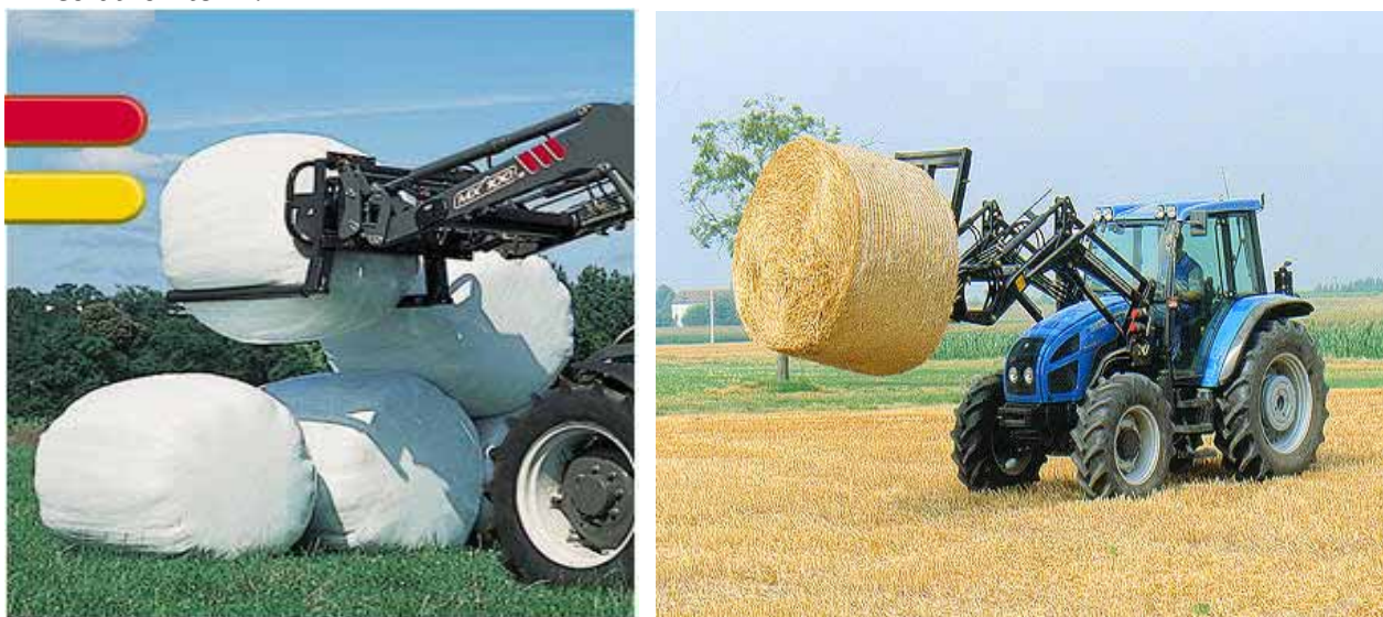
Fig. 2 - Le modalità di caricamento delle (roto)balle possono prevedere o il sollevamento vero e proprio, modalità da preferirsi decisamente in caso di balle di foraggio semiaffienato e successivamente fasciate (a sinistra), oppure infilando direttamente le forche nella o nelle (roto)balle (a destra).
