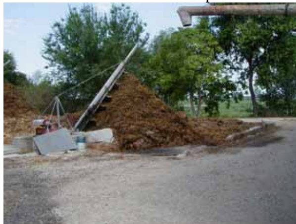
Figura 13 – Letamaia con tipico cumulo conico generato dal trasportatore meccanico.
