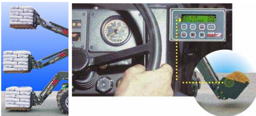
Fig. 9 - I dispositivi di autolivellamento meccanico o idraulico dell'attrezzo, ad esempio della benna (a sinistra), e i sistemi per la pesatura continua e in automatico del carico, dotati o meno di allarmi per superamento di limiti preimpostati (a destra), risultano utili per limitare il pericolo di caduta di materiale movimentato sopra al trattore e in particolare sopra l'abitacolo.
