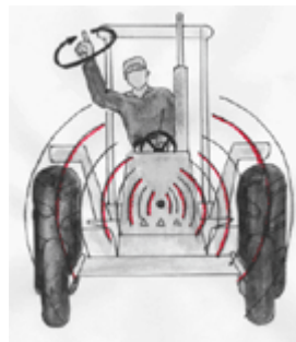
Fig. 3 - Sul trattore, come su altri mezzi da lavoro anche in campo industriale, l'avvisatore acustico non serve solo per segnalare il sopraggiungere del veicolo, ma spesso è utilizzato per indicare l'accensione del motore e l'inizio del movimento e per altre funzioni di avvertimento, più o meno convenzionali.
