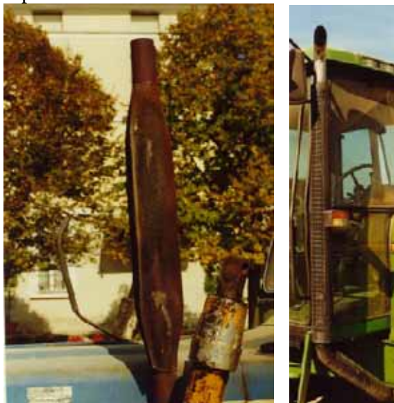
Fig. 49 - Il silenziatore montato deve sempre essere quello originariamente previsto dal costruttore.
