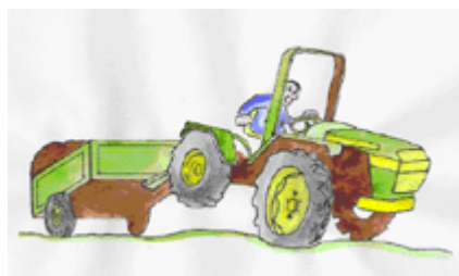
Fig. 10 - Se si verificano frenate lunghe, sbandamenti, saltellamenti, ecc. è necessario far registrare gli organi frenanti e/o provvedere alla sostituzione dei dispositivi di usura (pastiglie e/o dischi).
