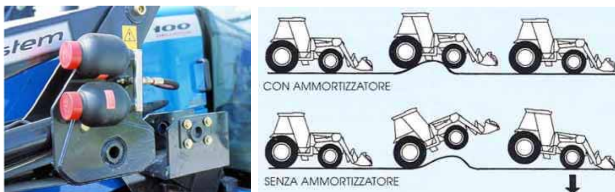
Fig. 13 - Gli assorbitori di shock ad azoto sono in grado di migliorare significativamente l'operatività, specie in caso di marcia veloce e su superfici irregolari.
