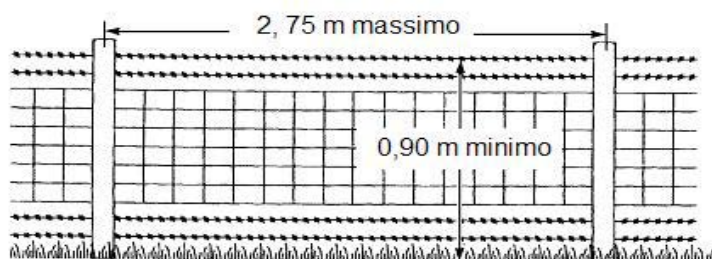
Figura 1 - Esempio di recinzione a protezione di vasche per deiezioni.
