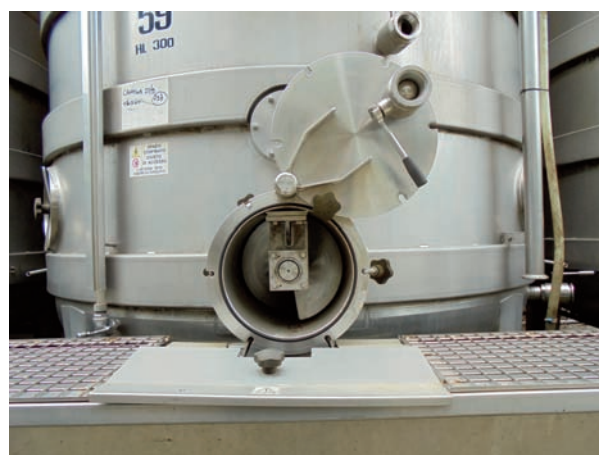
Base fermentino - zona scarico vinacce
