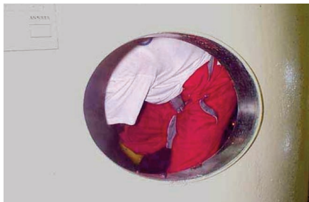
Addetto all'estrazione delle vinacce all'interno del vaso
