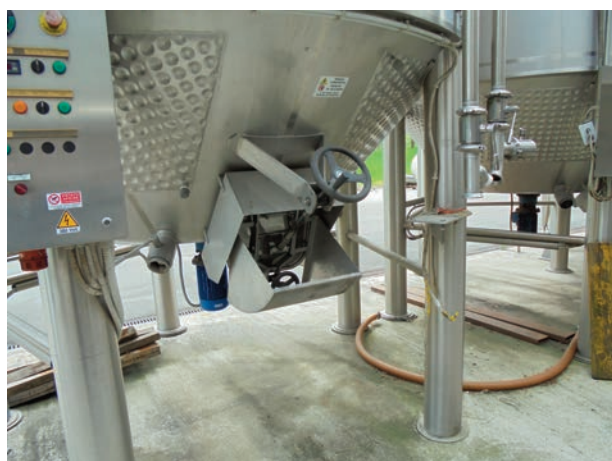
Fermentino - dispositivo scarico vinacce
