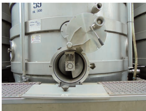
Base fermentino - zona scarico vinacce
